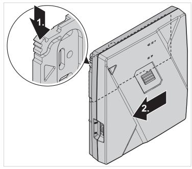
Fig. 12 Disengaging the sensor module
